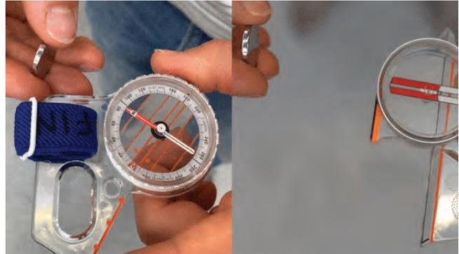
Le test de rapidité consiste à maintenir l'aiguille de la boussole à 90° par rapport au nord (à l'aide d'un électroaimant), puis à la relâcher et à mesurer le temps mis pour revenir à sa position d'équilibre. L'aiguille est filmée selon une vue de dessus, ce qui permet de récupérer sa position angulaire avec un logiciel de pointage vidéo.
