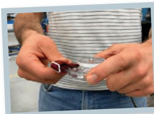
Comme le décalage de l'aimant par rapport au centre de l'aiguille est toujours inférieur au millimètre, il est très difficile de le mesurer précisément. Il est cependant facile de mesurer l'erreur de l'aiguille par rapport au nord si la boussole est penchée d'un certain angle par rapport à l'horizontale.
